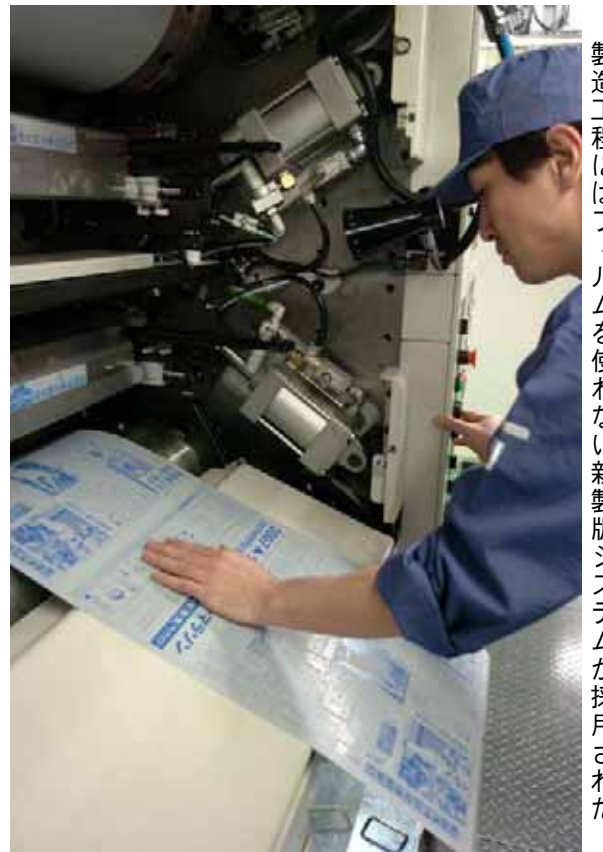
製造工程にはフィルムを使わない新製版システムが採用された
