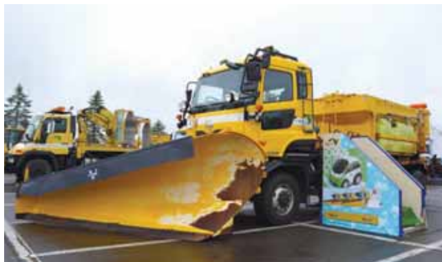
高速道路用除雪車 前方に長さ29メートルの除雪用プラウ(板)を、車体中央に整地用のグレーダーを備えた大型除雪車。時速30~40キロで作業でき、高速道路ではおおむね積雪5センチになると3台一組で出動する。
