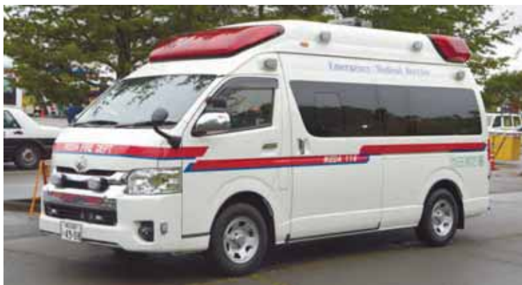
高規格救急車 別名「走る救急救命室」と呼ばれる。池田消防署が昨年2月に導入したばかりの新型車は人工呼吸器や自動心臓マッサージ器などを備え、救急救命士が乗り込んで急病人や心肺停止状態の負傷者を救命処置しながら病院に運べる。天井を上げて185センチの室内高を確保し、作業性に優れる。
