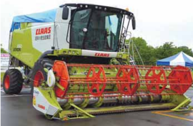
小麦用コンバイン ドイツ・クラス社製の大型コンバイン。排気量8800cc、313馬力の大型エンジンを搭載し、幅5メートルほどのカッターで小麦を一気に刈り取って、そのまま脱穀する。十勝は小麦の有数の産地で、米国製など外国製の大型農機が多く活躍している。
